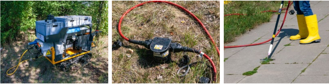
Abbildung 1-3: Rootwave-Pro-System (links); Bezugsselektrode mit 20 Meter Behandlungskabel (mittig); Applikation mit der Handlanze an Vogelknöterich in Gehwegfugen (rechts). Quelle: P. Boas, Pflanzenschutzamt Berlin.
