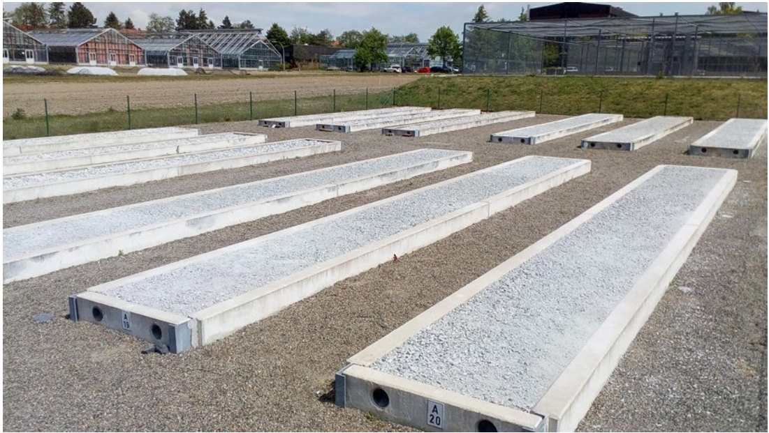
Abbildung 1: Modell-Versuchsfläche zum Vegetationsmanagement auf bzw. an Gleisanlagen im JKI Braunschweig (Schotter- und Kiesflächen), Quelle: JKI.
