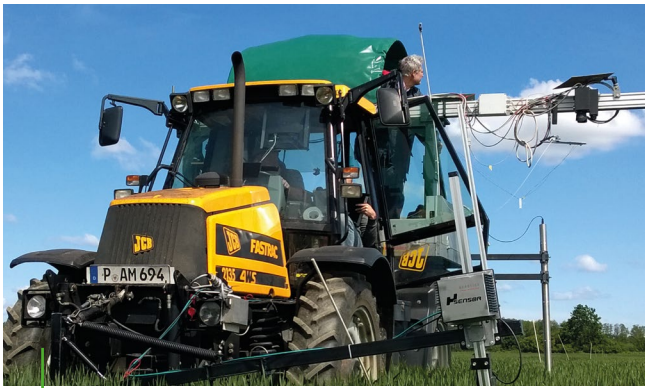
Sensor zur frühzeitigen Erkennung von Gelbrost im Feldtest.
