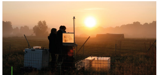
Messung von Treibhausgas-Emissionen eines Moorbodens am frühen Morgen.
