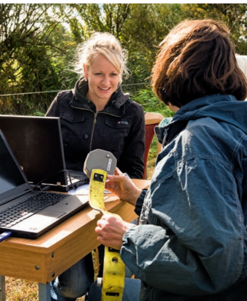
Der Transponder um den Hals misst Herzschlag und Körpertemperatur der Rinder. Darüber hinaus speichert er ihren Aufenthaltsort. Am Computer werden die Daten von Expertinnen des Leibniz-Zentrums für Agrarlandschaftsforschung ausgewertet.
