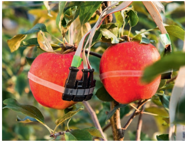
Der kleine „Rucksack“ ist ein Sensor. Er misst, in welchem Zustand der Apfel ist. Die Ergebnisse lassen sich dann auf einem Smartphone auswerten.
